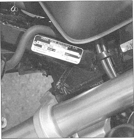
Emplacement de la plaque constructeur sur le cadre près de la colonne de direction.
